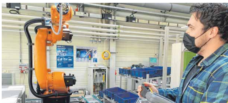
Es funktioniert: Ein Student steuert die Montagezelle an, die aus zwei Industrierobotern und einem Fördersystem besteht. FOTO: HOCHSCHULE
